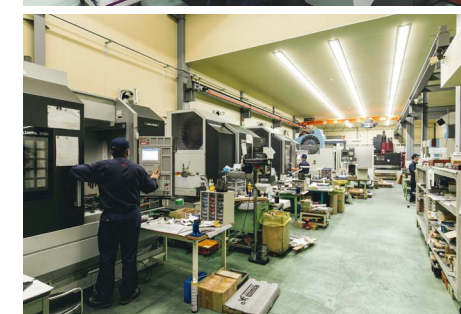
上：桜三里にある工場では超微細加工ができる高速加工機を導入 下：プログラムの指示や器具の選び方など、どこまでいっても技術者の力が重要
