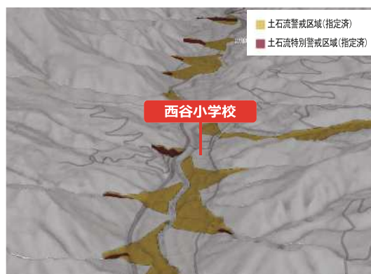
図 西谷小学校周辺（土石流）
