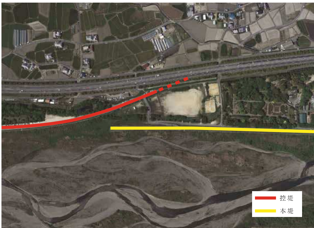
写真3-89 井口霞本堤・控堤
