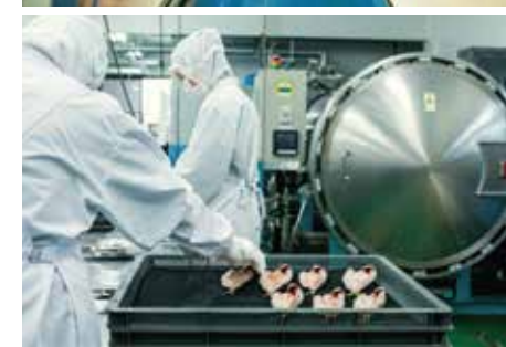
上:仕入れた大量の魚をさばき水洗いし、乾燥の工程へ 下:高温高圧釜で蒸気を循環させ、骨まで柔らかくする
