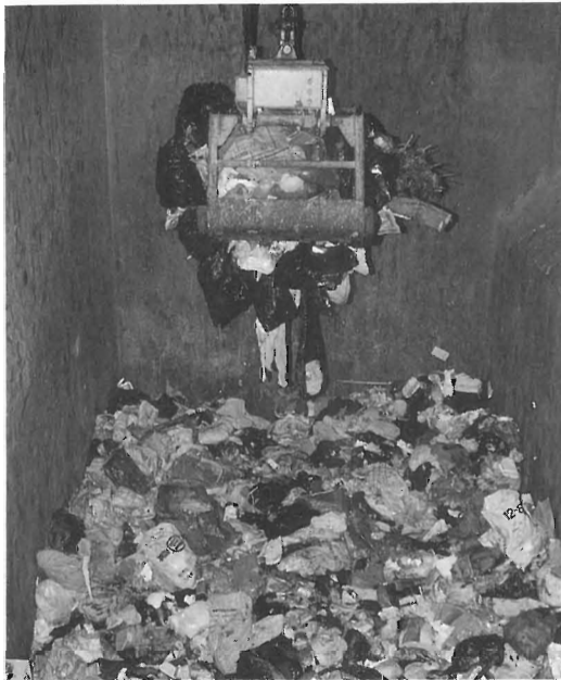
ピットからクレーンにより炉へ運ばれるごみ
