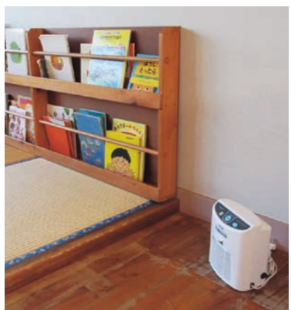
遊戯室に設置されたオゾン除菌脱臭器
