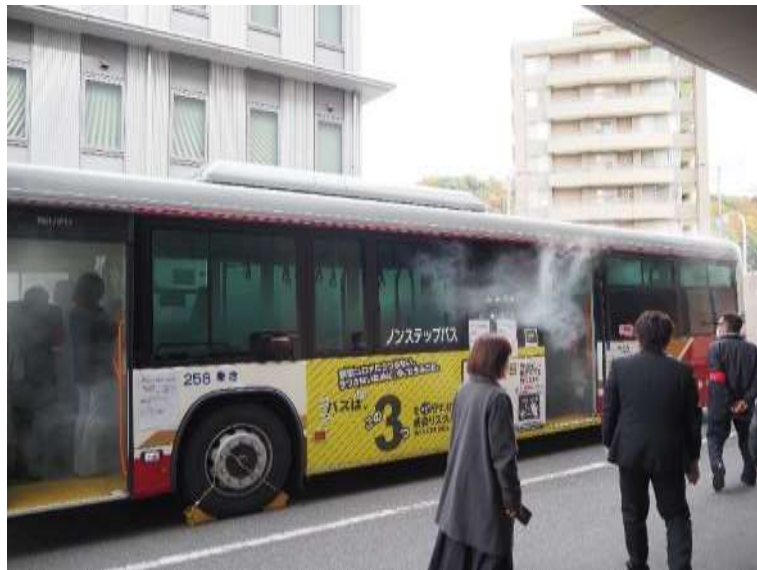
図 49 バス換気性能実験（JCOMM 広島大会）
