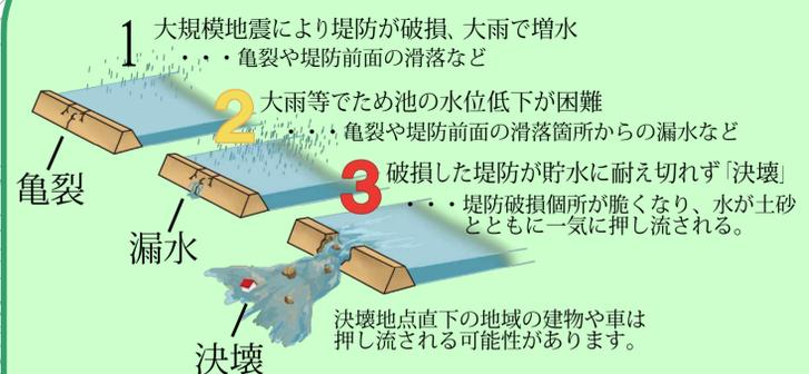
緊急時には、ため池の水位を低下させるなど、決壊を防ぐための処置が行われます。
