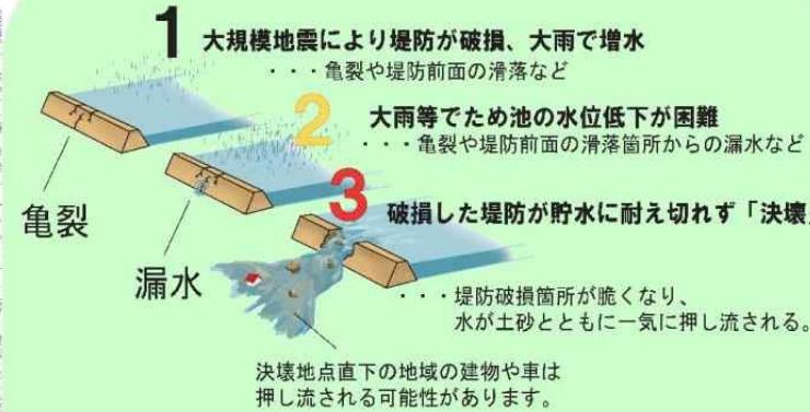
緊急時には、ため池の水位を低下させるなど、決壠を防ぐための処置が行われます。
