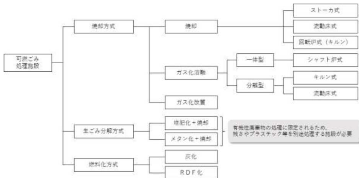
図 5-2 可燃ごみの処理方式
