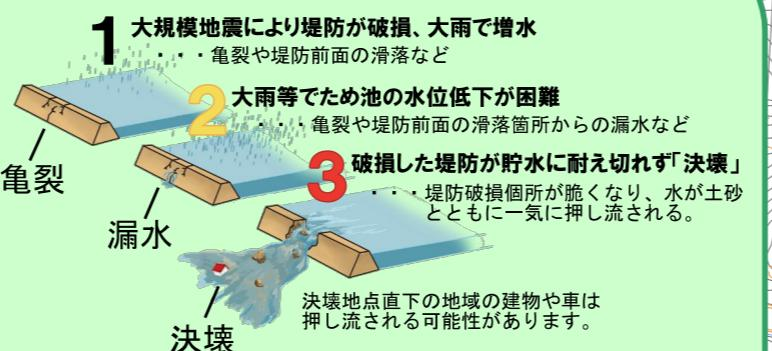
緊急時には、ため池の水位を低下させるなど、決壊を防ぐための処置が行われます。
