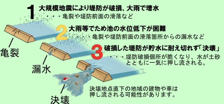
緊急時には、ため池の水位を低下させるなど、
